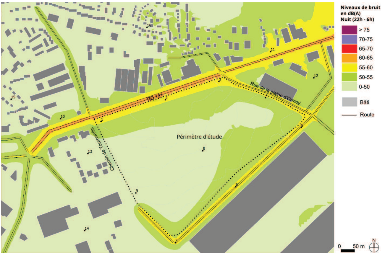
Niveaux sonores Ln (nuit) calculés à l'horizon 2022 sans la ZAC (source TRANS-FAIRE, 2016)
